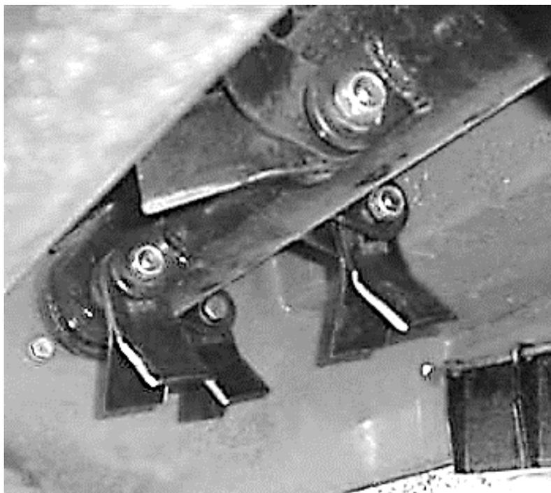
Ножи устанавливаются на проушины, расположенные на вращающемся валу болтовыми соединениями
