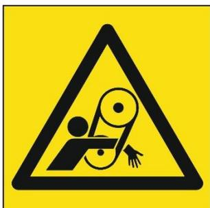
Косилка в своём составе имеет ременную передачу. Высока опасность затягивания одежды и рук между ремнем и шкивами с причинением серьёзных травм.
