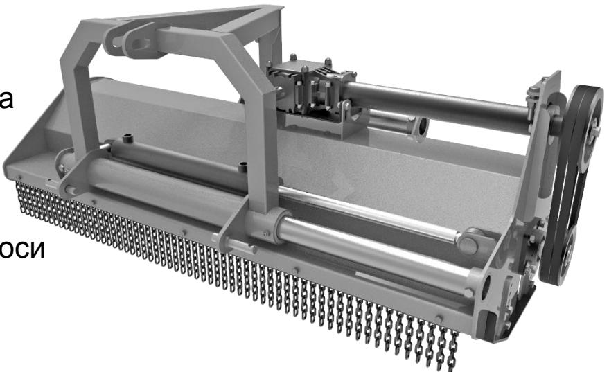
Сдвижная косилка агрегатируется с трактором, оснащенным доп. гидораспределителем. Ход штока 400 мм; 75 мм в сторону дороги и 325 мм в сторону обочины.
